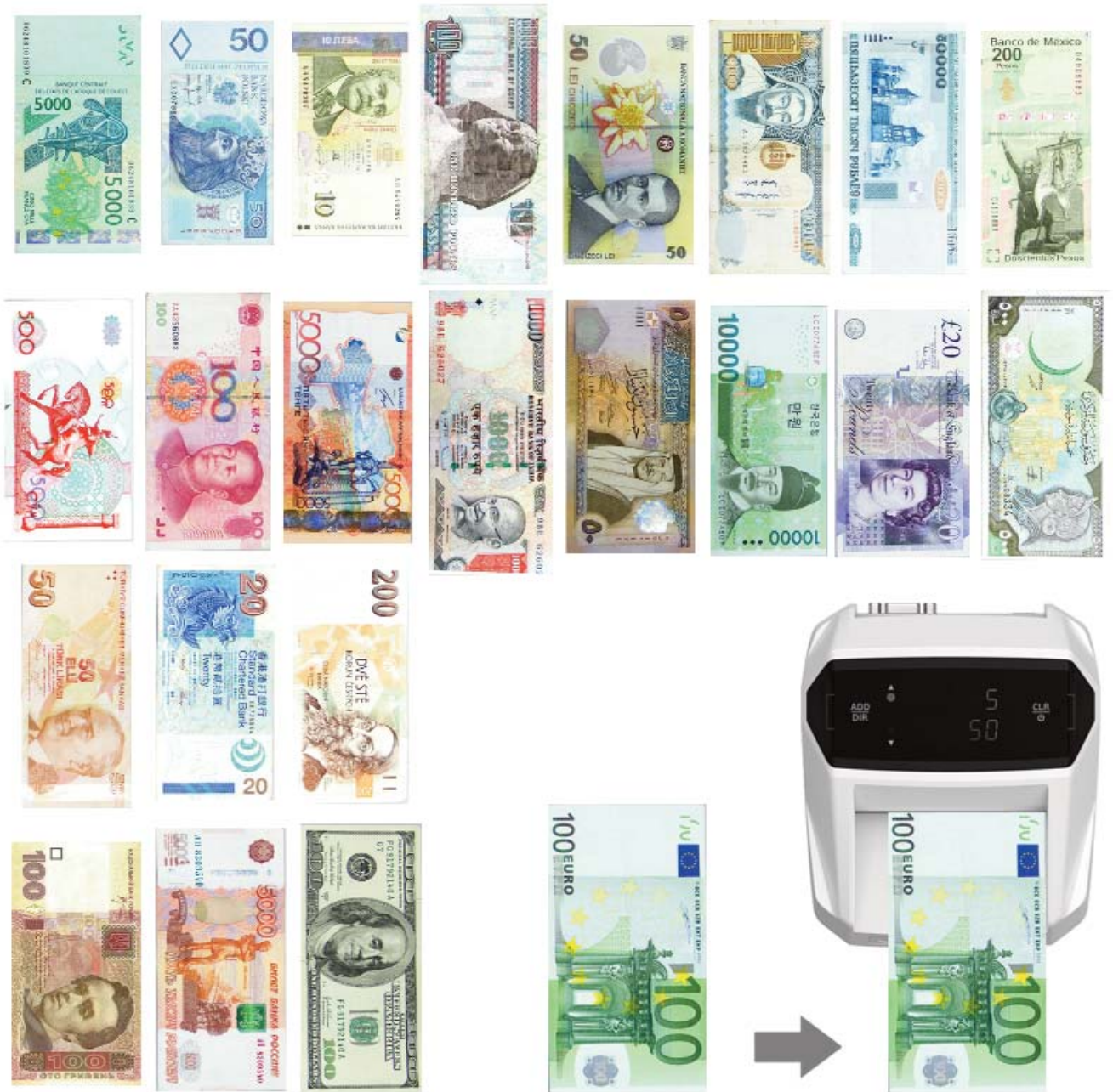
Abbildung . 4 MONIRON DEC MULTI. Die richtige Lage der Banknoten
